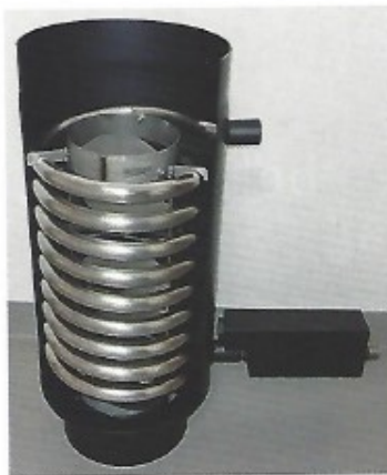
Der aufgeschnittene TurbuFlex Wärmeübertrager ist in der Ausstellung der Schornsteinfegerakademie in Dülmen zu sehen. Ein weiteres Exemplar ist bei der DOMUS/BUZ NRW in Iserlohn ausgestellt.
